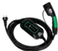
Standardni kabel za punjenje s utikačima Txpe 2 i Schuko 1-faznim 230V utikačem, maks. 3 kW punjenja. 3 m, A464571
