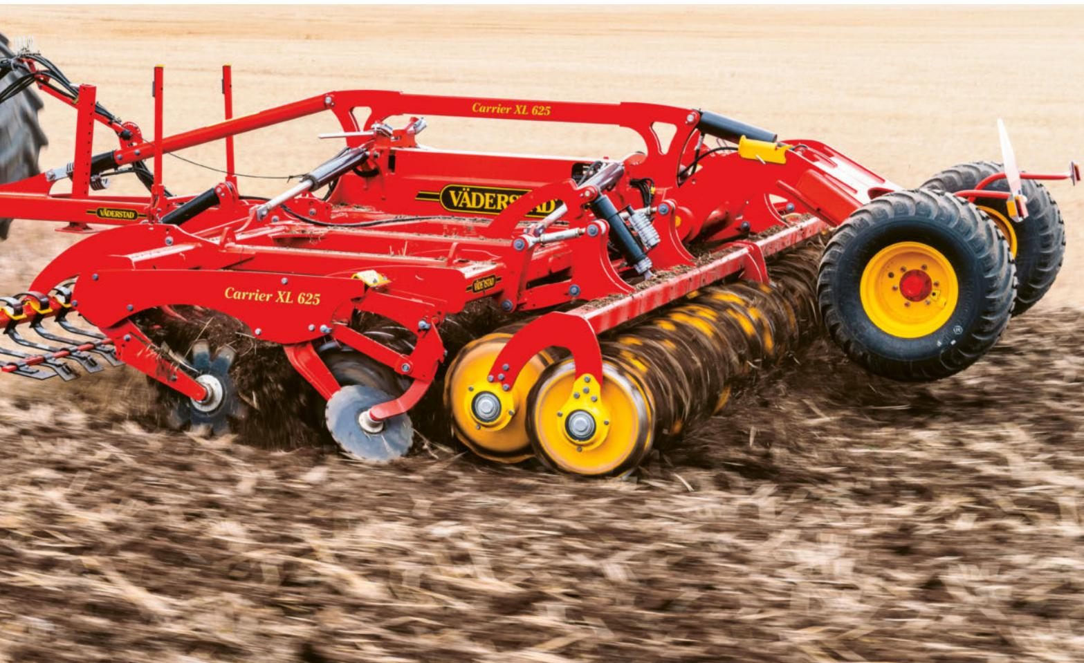
Carrier XL 425-625 može biti opremljen sa 510 ili 610mm diskovima sa podesivim kutem rada.
