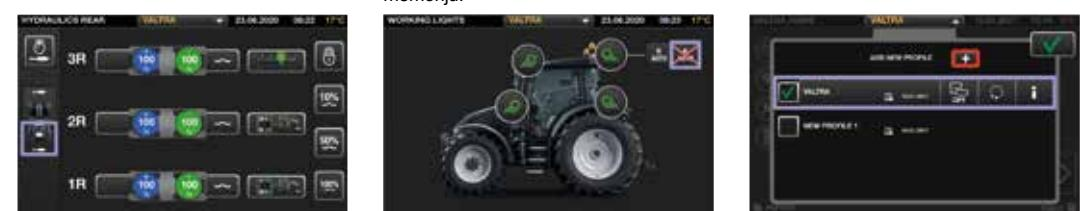
Možete postaviti bilo koju kontrolu za rad sa bilo kojom hidrauličkom funkcijom, uključujući prednje i zadnje hidrauličke ventile, prednje i zadnje poluge hidraulike i prednji utovarivač.
