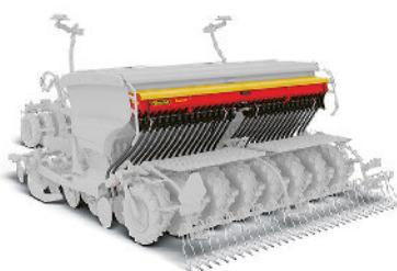
*Rapid 300-400 C/S može biti opremljen sa BioDrill 180-250. Ima gravitacijski sustav raspodjele sjemena sa svega nekoliko pomicnih dijelova i samim time minimalnim zahtjevima za održavanje i dugačkim radnim vijekom.*
