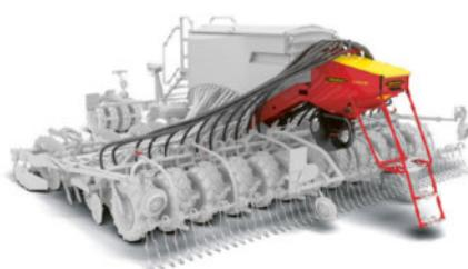
*Rapid A 400-800S i Rapid A 600-800C mogu biti opremljeni sa BioDrill 360. Pneumatski BioDrill 360 je opremljen sa električni pogonjenim Fenix II sustavom za raspodjelu što omogućava ujednačenu sjetvu sitnozrnatih usjeva uz preciznost do sjetvene norme od 1 kg po hektaru.*
