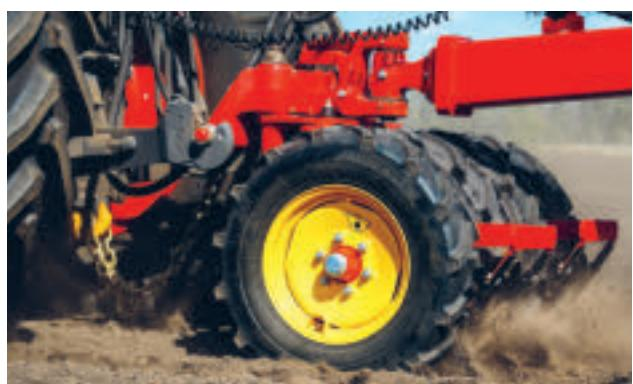
Pivot packer kotači konsolidiraju tlo između kotača traktora omogućavajući da svako sjeme ima jednake uvjete za nicanje.
