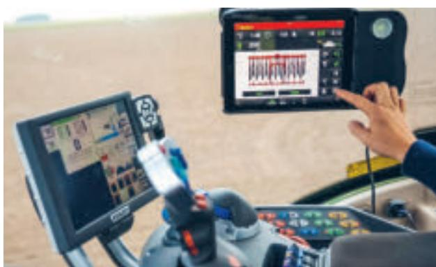
Sjeme se raspodjeljuje sa dva Fenix III sustava od kojih je svaki zadužen za jednu polovinu stroja što omogućava gašenje pola radne širine stroja iz kabine traktora.
