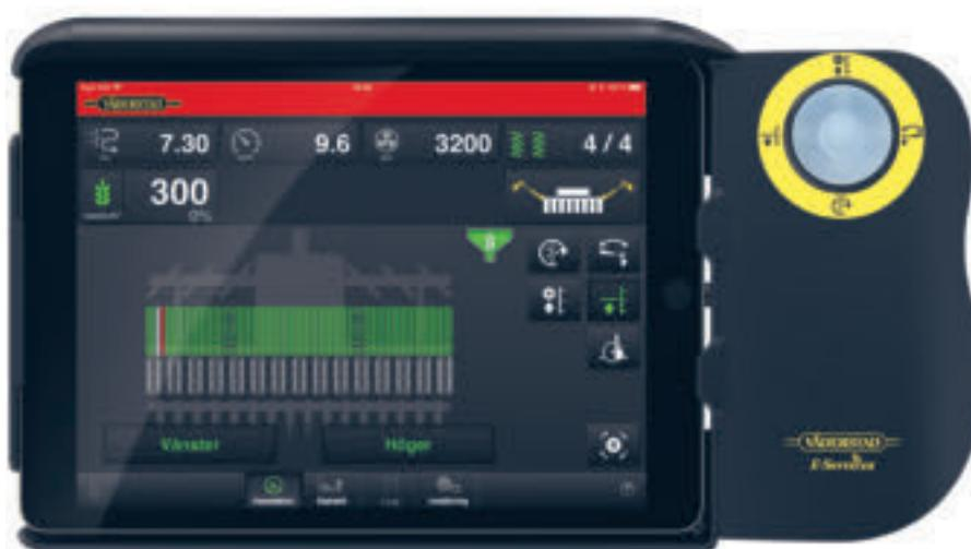
Kompletan sustav SeedEye s brojenjem sjemenki i nadzorom blokade dostupan je za Spirit 600-900S, dok su Spirit R 300S, Spirit 400C/S i Spirit 600-900C ograničeni samo na iskorištenje funkcije nadzora blokade sustava SeedEye.
