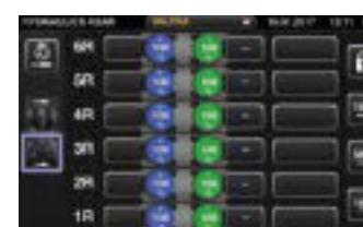
Možete dodjeliti bilo koju kontrolu za rad s bilo kojom hidrauličkom funkcijom, uključujući prednje i zadnje hidrauličke ventile, prednje i zadnje poluge hidraulike i prednji utovarivač.
