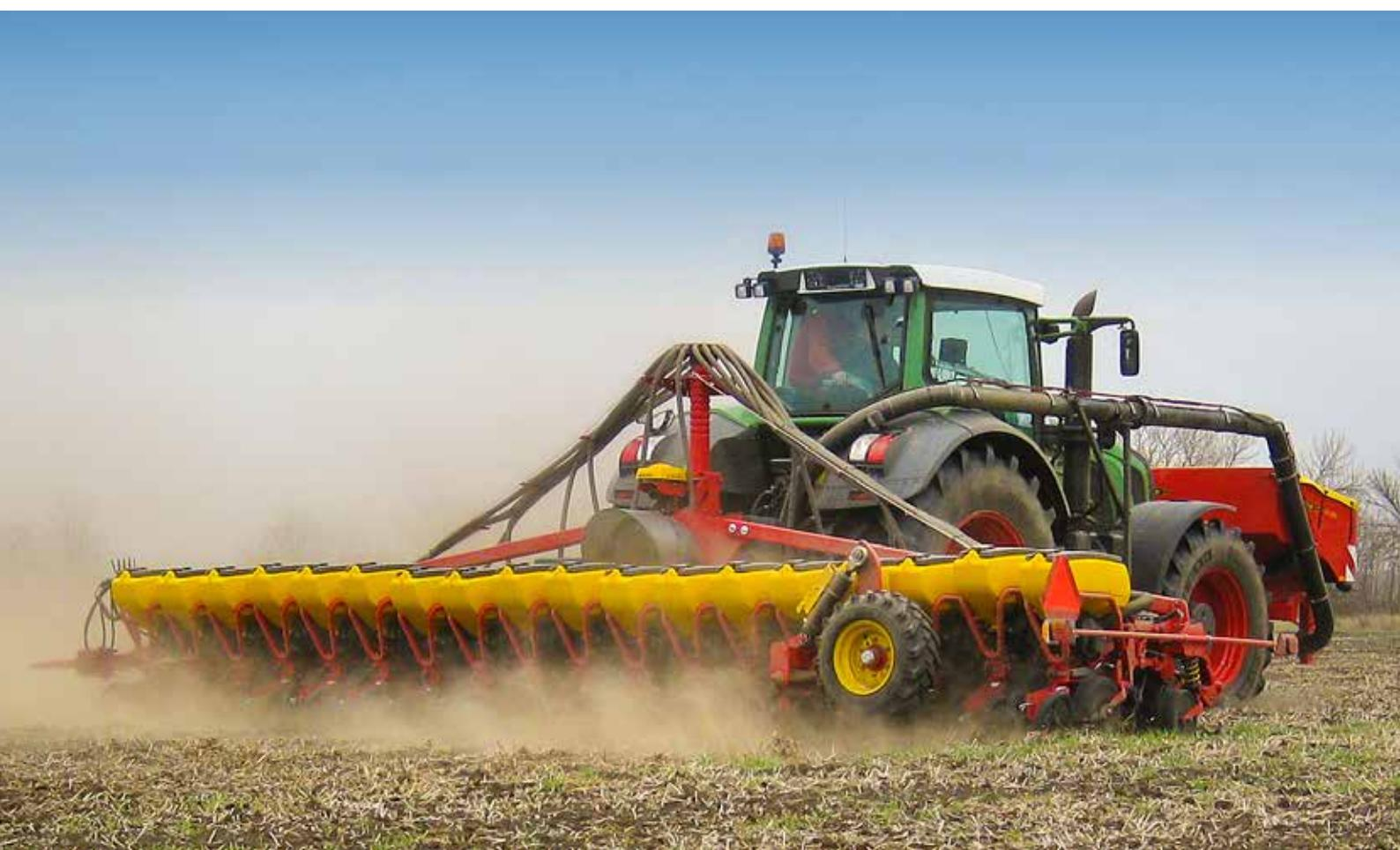
Spajanje na trotoče traktora omogućava izvrsnu upravljivost i male uvratine. Dodatno, fiksna greda donosi manje pokretnih dijelova, minimalnu težinu i smanjenu potrebu za održavanjem bez gubljenja izvrsne preciznosti koju nudi Tempo R.
